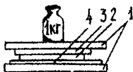
Рис. 4. Определение ВУС методом прессования
