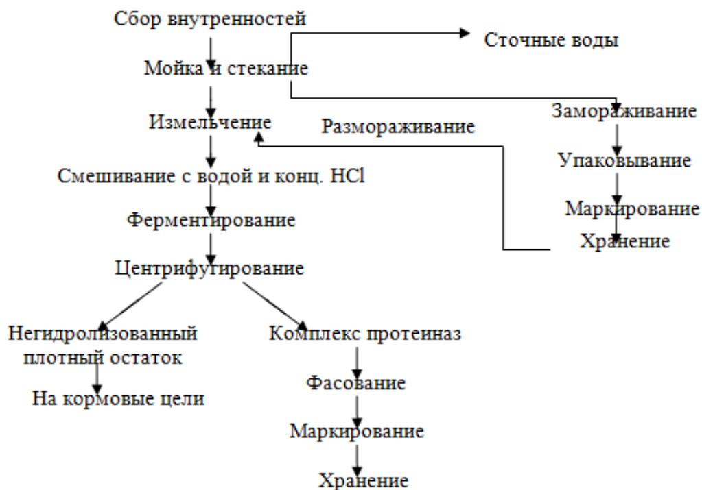
Рис. 1. Схема технологического процесса получения ферментного препарата-комплекса протеиназ
