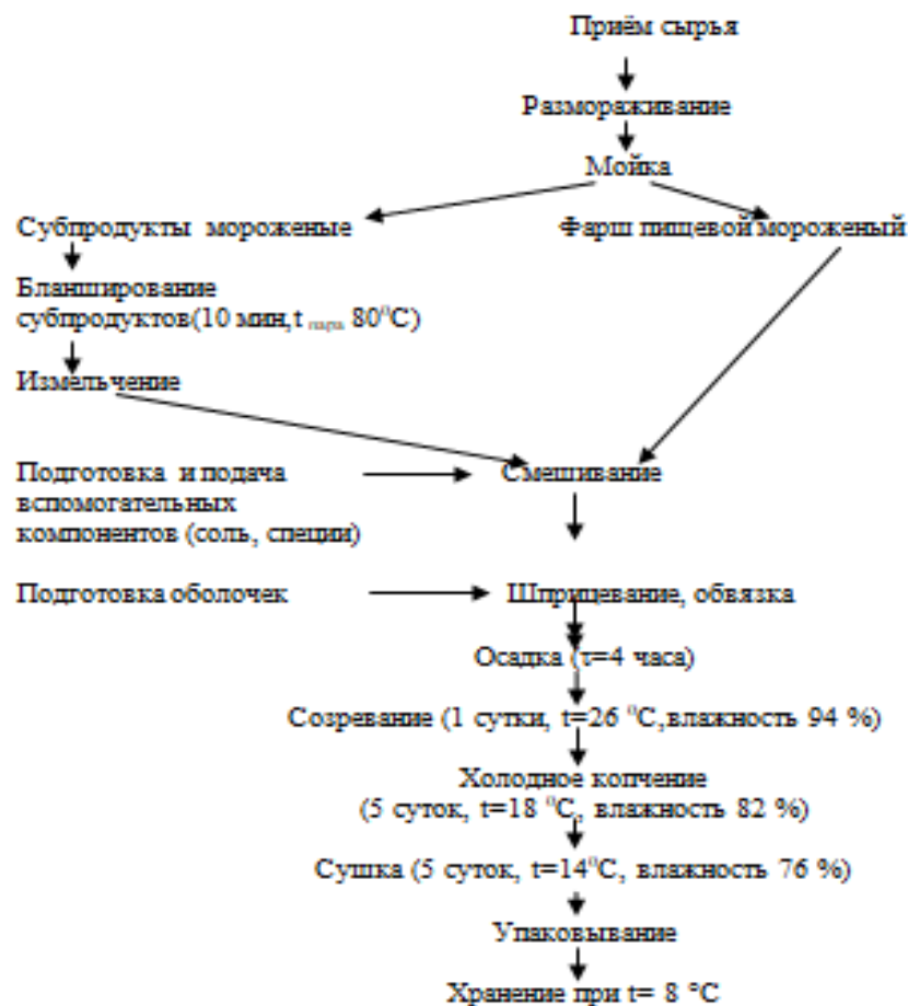
Рисунок 1 - Технологическая схема изготовления сырокопченой колбасы
