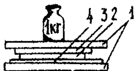
Рис. 4. Определение ВУС методом прессования
