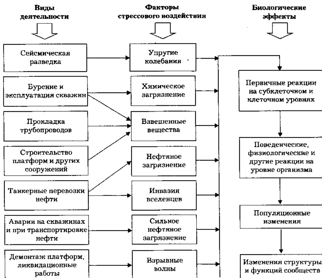
Рис. 4. Характер, структура и последовательность биологических откликов при рачных видах воздействия на морские экосистемы в процессе освоения нефтегазовых месторождений на шельфе
